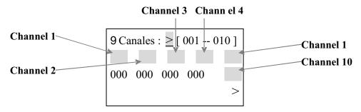
Puede configurar los valores de estos 10 canales. Por ejemplo, localice el cursor del canal deseado, presione el multiselector para seleccionarlo, Gire el multiselector para ajustar el nivel. Cuando esté satisfecho con el ajuste, presione el multiselector otra vez para confirmar la configuración.
