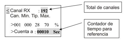
Nota: El valor mínimo mostrado, es el mínimo valor de todos los ajustes referidos al presente canal, el valor típico es el valor configurado en el canal actual, el máximo mostrado es el máximo valor de todos los ajustes referidos al canal actual. Para visualizar el valor de cada canal, gire el multi-selector a > en la tercera línea de la pantalla, entonces presione el multi-selector. Ahora puede visualizar el canal deseado, girando el muti-selector hacia delante o atrás
