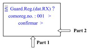
Para algunas pruebas, primero localice el signo > en la parte 1 para seleccionar la función deseada. Entonces localice el signo > en la parte para ajustar el nivel girando el multiselector.
