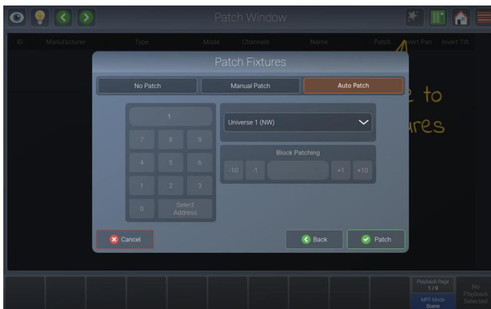
**Fig. 39: Agregar un dispositivo - Asignar la dirección**
