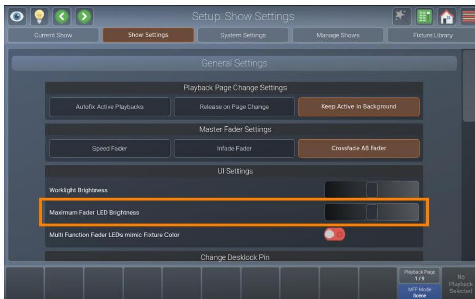
Fig. 55: Ajustes del espectáculo - Máximo brillo de los LED de los fader
