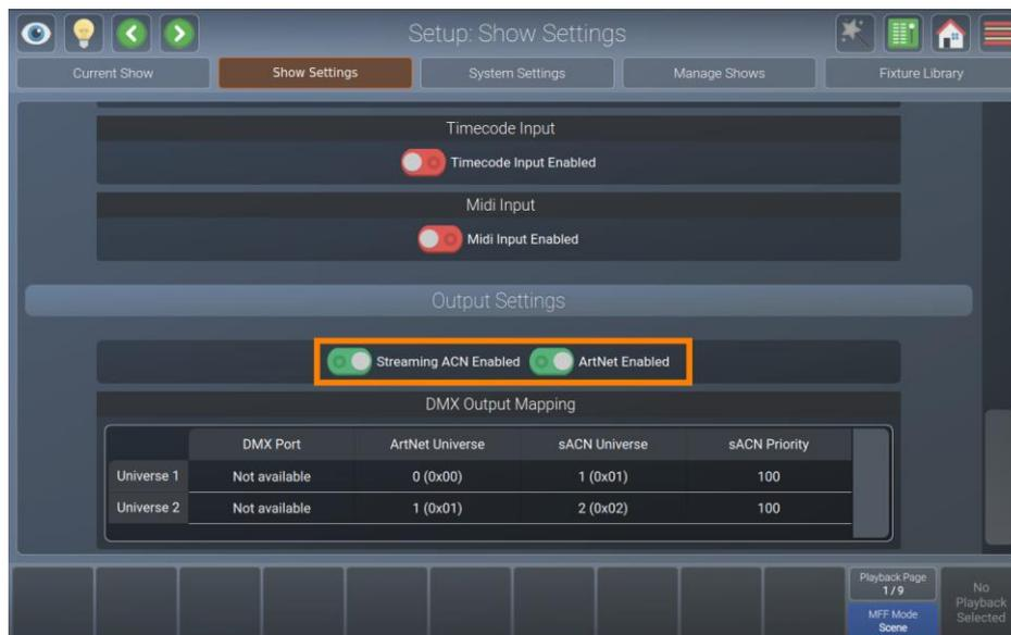
**Fig. 64: Show Settings- Configuración de salida DMX**
